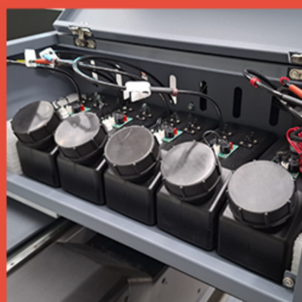
Sistema de secado por luz LED UV con refrigeración a base de agua
